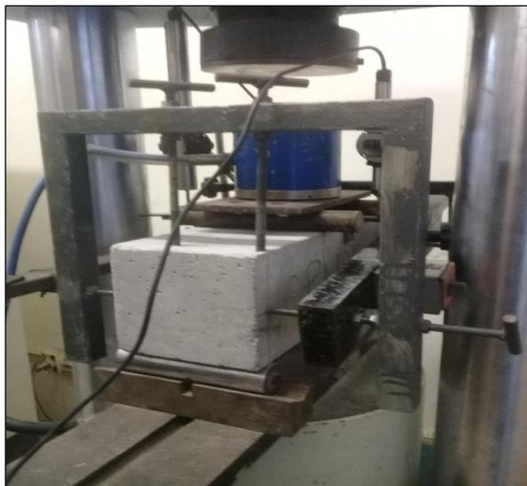
Figura 3.18- Suportes do dispositivo “YOKE”. Fonte: Autor.
