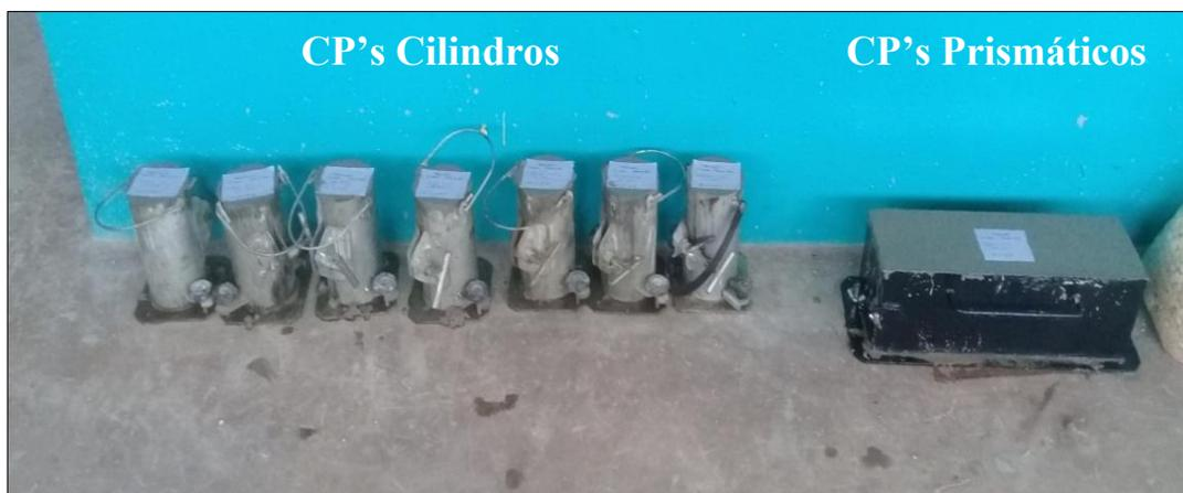
Figura 3.15- Corpos de prova cilíndricos e prismáticos moldados em formas metálicas.
