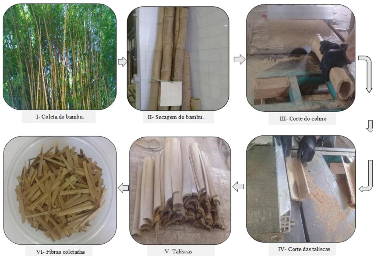
Figura 3.3 - Processo de obtenção da fibra de bambu. Fonte: (Autor).
